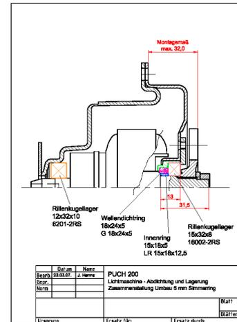
Beim Umbau der Motor-Kupplungs-Dichtung muss man auch an der Schwungscheibe einen Ansatz abdrehen.
