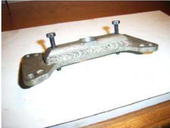
Er ist für das Anpressen der Kupplungs-Anpressplatte gegen die Kupplungs-Federkraft, damit man den kleinen Querkeil lockert und ausbauen kann. Auch mit Schraubzwingen kann man diese Arbeit machen.
